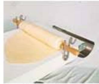
Cuando la pasta está laminada al espesor deseado, se enrolla automáticamente en el específico rodillo.
