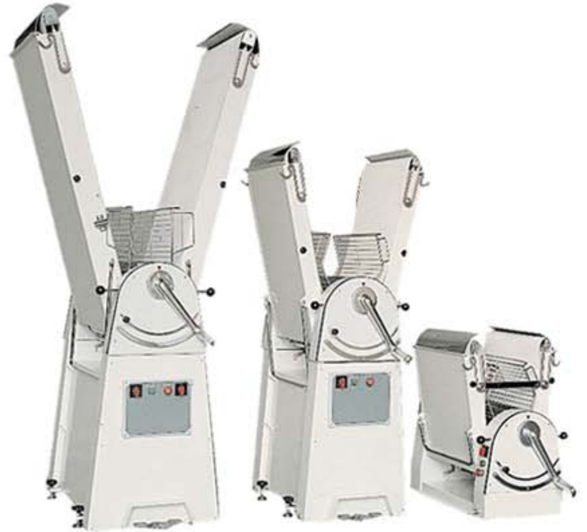
Cuando la pasta está laminada al espesor deseado, se enrolla automáticamente en el específico rodillo.
